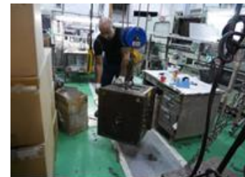
金型交換作業の様子
